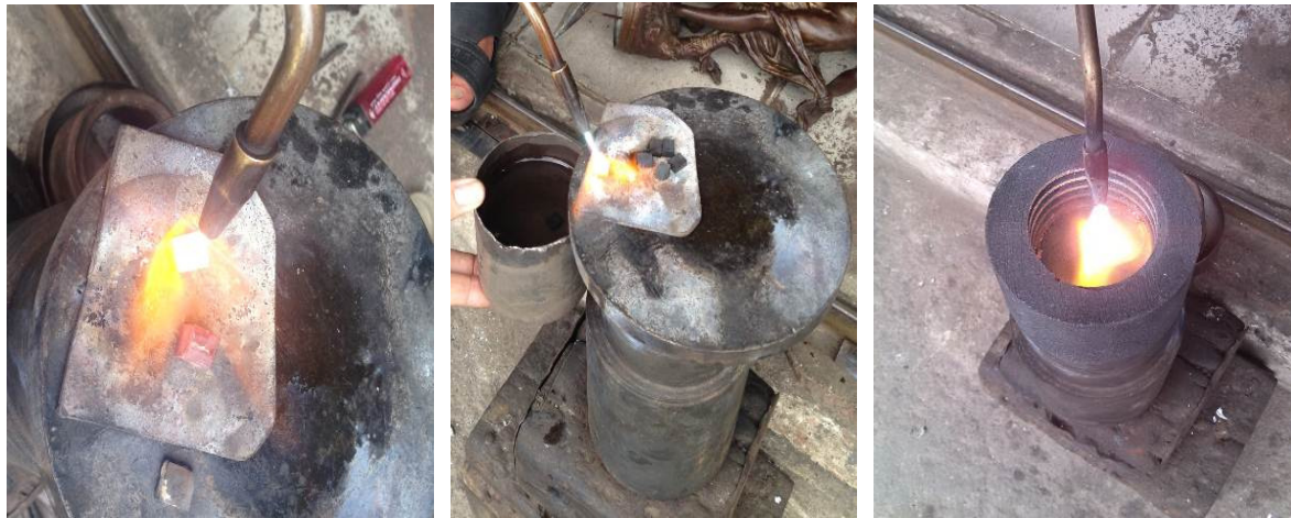
Hình 3. Hình ảnh thử nghiệm khả năng chịu nhiệt, chịu sốc nhiệt của composit.
