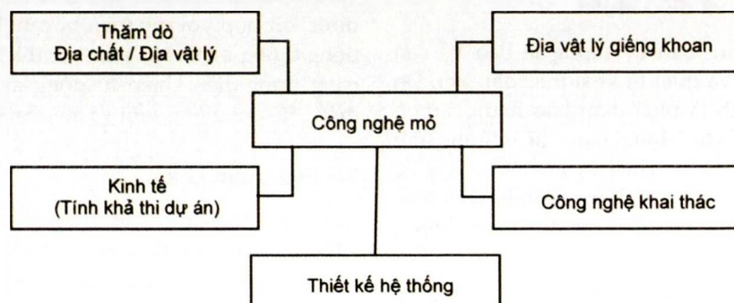
Hình 1. Vị trí của Công nghệ mỏ trong mối quan hệ giữa các hoạt động dầu khí.
