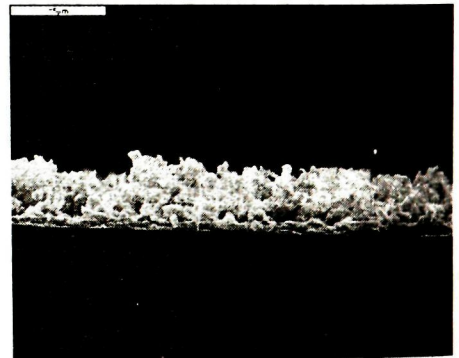
Hình 3. Ảnh SEM cấu trúc bề mặt của màng \text{SnO}_2 : Sb (2 at. %) ở T = 410^\circ\text{C} a - Ảnh chụp bề mặt b- Ảnh chụp mặt cắt ngang
