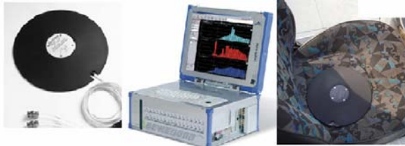
Hình 4.17&4.18 DEWE5000 và đĩa đo dao động Dytran 5313A
