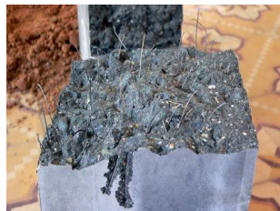
Hình 3.5. Dạng phá hoại cốt sợi
