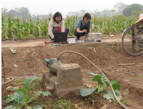
Hình 3.38. Hình ảnh minh họa việc thực hiện phân tích sử dụng thiết bị phân tích hiện trường CE-C 4 D
