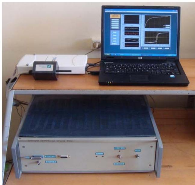
Рис. 13. Внешний вид экспериментального устройства для контроля магнитных свойств деталей
