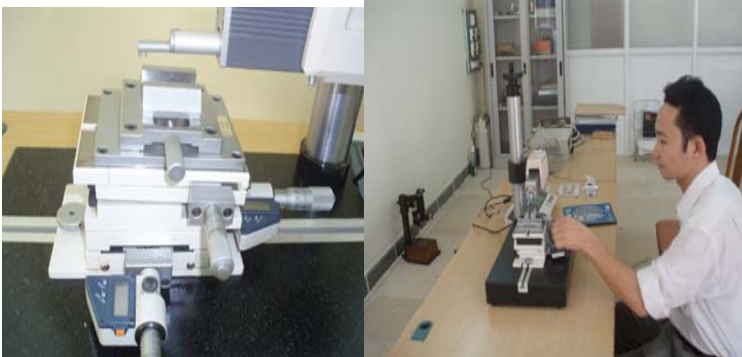
Hình 4.10. Bộ gá mẫu đo và hiệu chỉnh máy đo độ nhám SJ-400 của Nhật Bản
