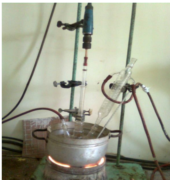
Hình 2.1 Sơ đồ thiết bị phản ứng điều chế BHE-BPA từ PC phế thải
