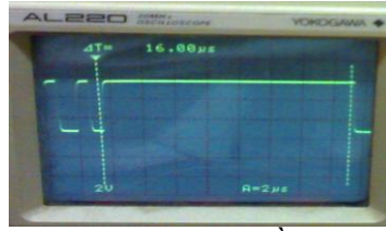
b) Mã ICAO tạo bằng vi điều khiển
