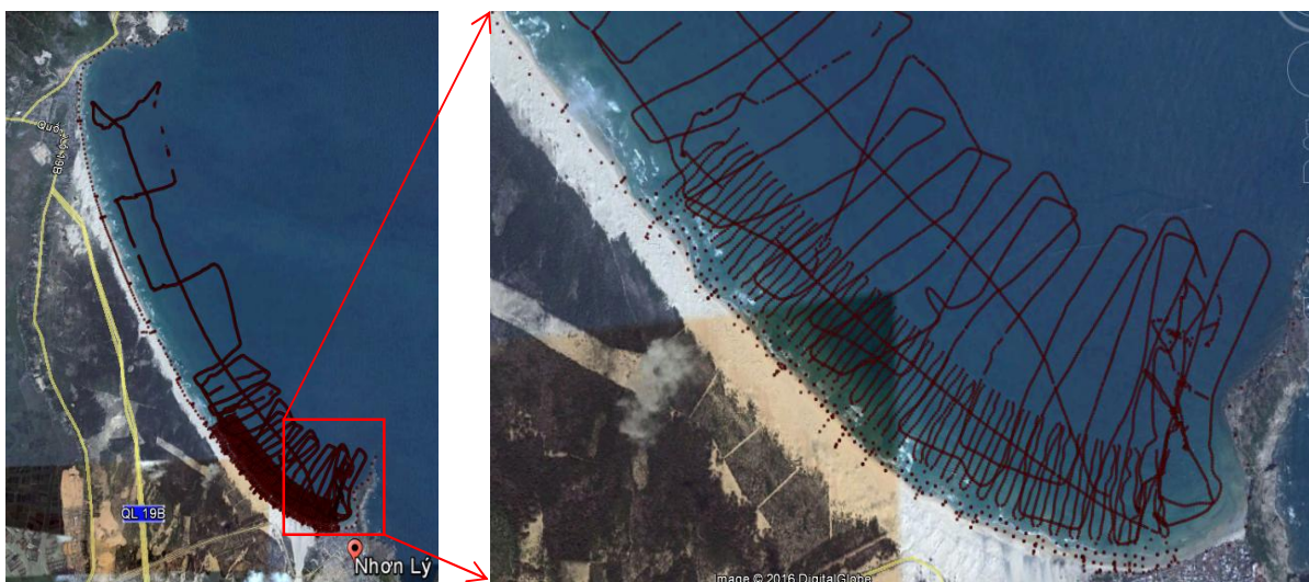
Hình 3. Các tuyến đo địa hình khu vực vịnh Nhơn Lý, Bình Định (tháng 4/2016).
