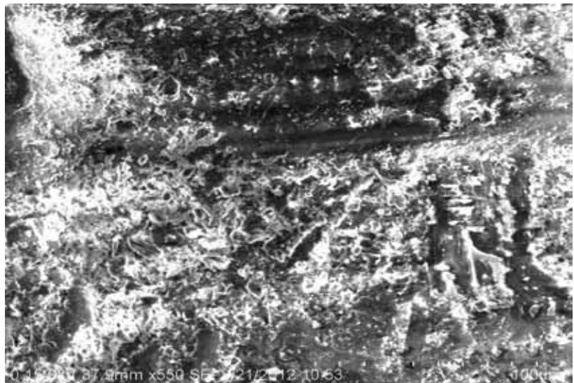
Vật liệu composite 2 pha nền polyester sợi thủy tinh thông thường.
