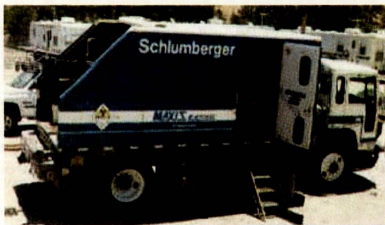
Hình 1. Xe tải chuyên dụng đo Địa vật lý giếng khoan của hãng Schlumberger (theo www.slb.com ).
