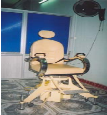
Hình 2.1: Thiết bị thử nghiệm khả năng chịu sóng
