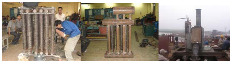
Hình 4.4. Một số hình ảnh chế tạo nồi hơi khí xả và bộ hâm nước tiết kiệm kiểu modulyon và lắp lên tàu để thử nghiệm
